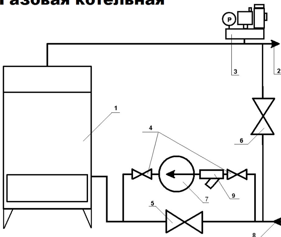
для этого специально ставится вентиль подмеса (см. схему, вентиль №6). В самом же котле конденсат может образовываться, но только в момент запуска.
